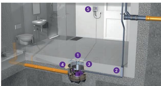
1 Подъёмная станция 2 Комплект напорных труб 3 Удлинительная секция 4 Комплект прокладок 5 Блок управления
